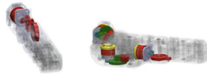
图：灵巧手蜗轮蜗杆传动原理
